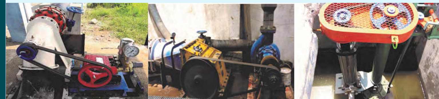
Turbin Propeller Tubular Tipe S dan Pompa Piston Turbin Crossflow dan Pompa Centrifugal Sinalastae Turbin Open Flume dan Pompa Centrifugal Multistage
